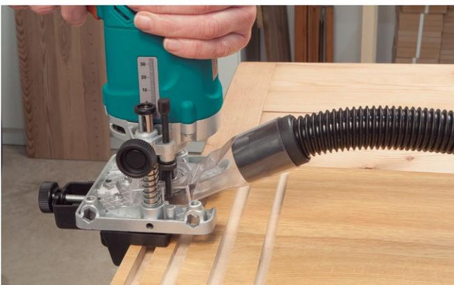
Profilage des chants tranchants (fraiseuse).
