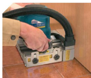
Découpe d'une porte jusqu'à 47 mm sans démontage.
